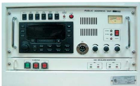
Система командной трансляции серии SNP предназначена для громкоговорящего оповещения экипажа и пассажиров судна о существенных событиях и аварийных ситуациях, а также для организации двухсторонней громкоговорящей связи между специфическими зонами судна, и для подачи пожарной и общесудовой тревоги. Система отвечает требованиям СОЛАС к аппаратуре судовой командной трансляции.
