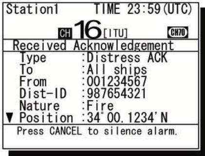
**(4) После подтверждения прием сигнала бедствия снимите гарнитуру и запросите помощь, используя канал CH16 радиотелефона.**
