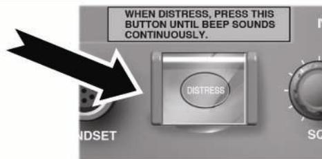
(2) Нажмите и удерживайте кнопку **DISTRESS** в течение 4 секунд (смотри примечание ниже). Как только таймер обратного отсчета истечет, будет передан сигнал бедствия.
