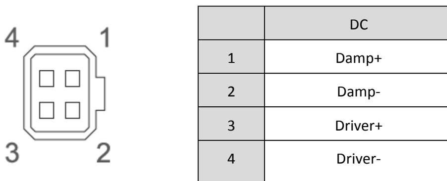
Рис.2.2. Назначение разъемов
