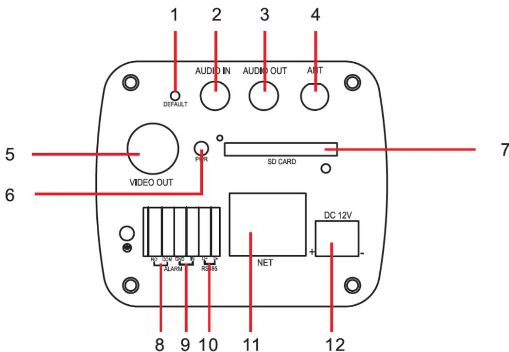
Рис.3.1. Разъемы задней панели LTV-ICDM2-E4230
