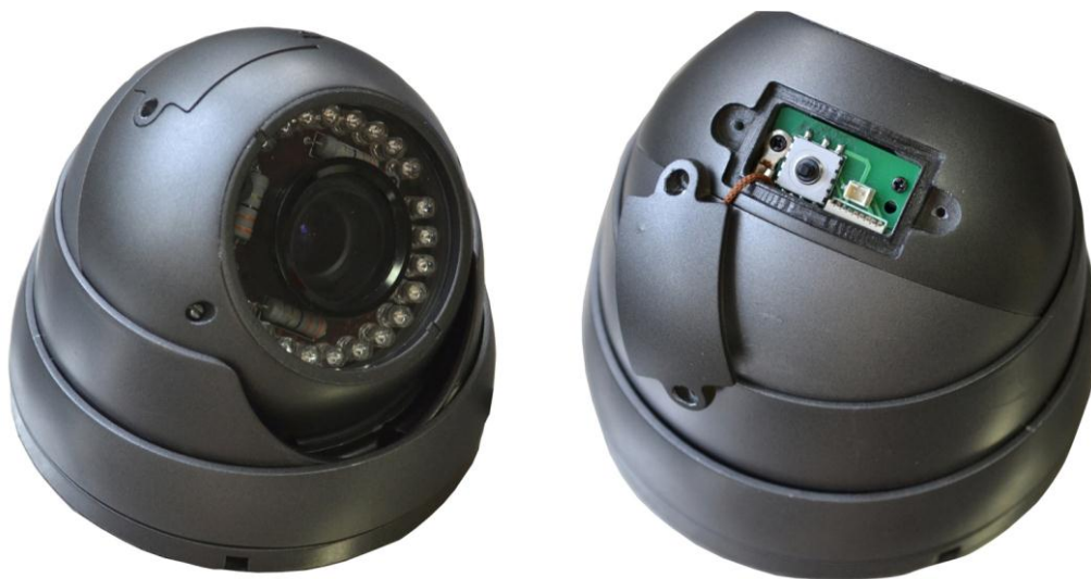
Рис.1.1.2. Вынесенное управление OSD-меню видеокамеры LTV-CDH-920LH-V2.8-12 (Series II)
