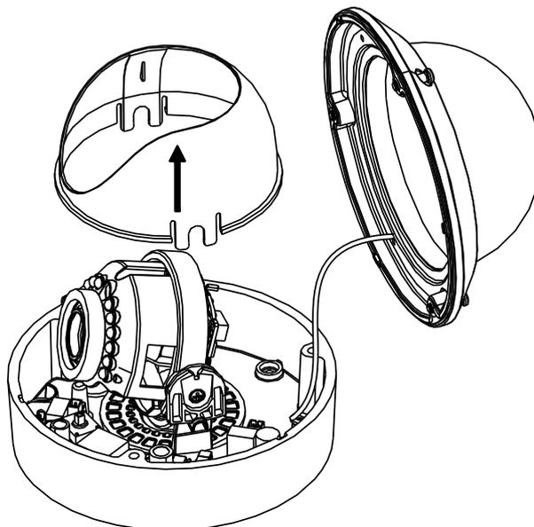
Рис.2.1.2. Установка видеокамеры LTV-ССН-800L-V
