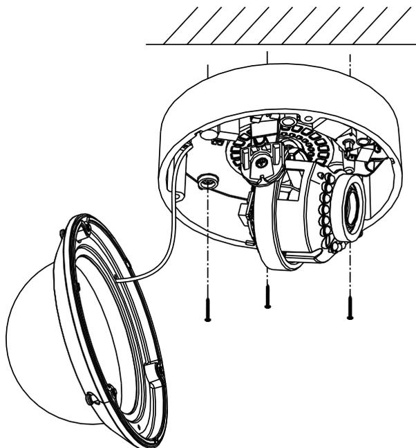
Рис.2.1.3. Установка видеокамеры LTV-ССН-800L-V
