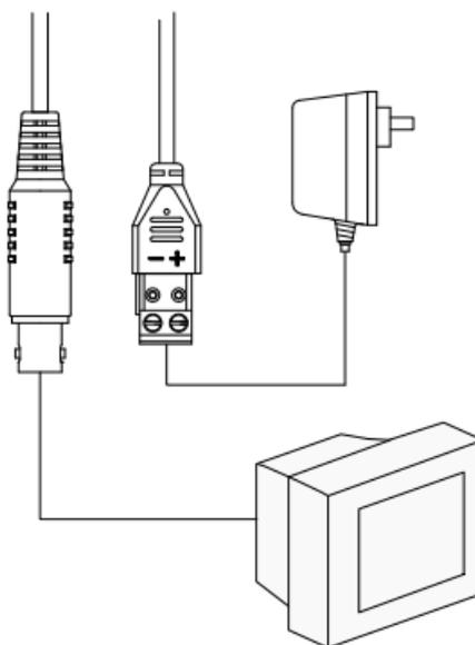
Рис.3.2.1. Подключение питания видеокамеры LTV-CCN-800L-V
