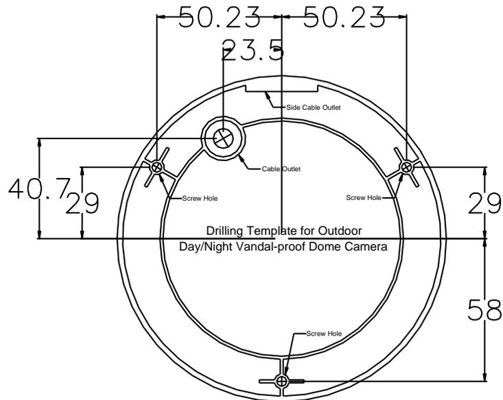
Рис.2.1.1. Шаблон для разметки крепежных отверстий
