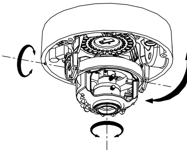
Рис.2.2.3. Настройка угла обзора и фокусировка объектива
