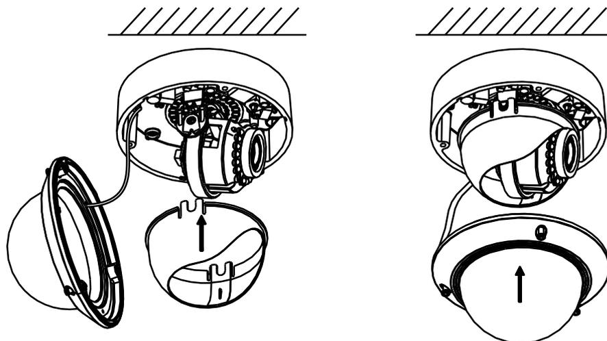
Рис.2.1.5. Завершение установки
