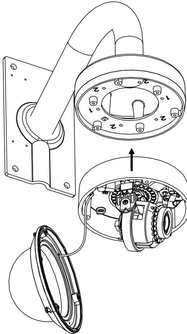
Рис.2.2.2. Монтаж камеры на кронштейн
