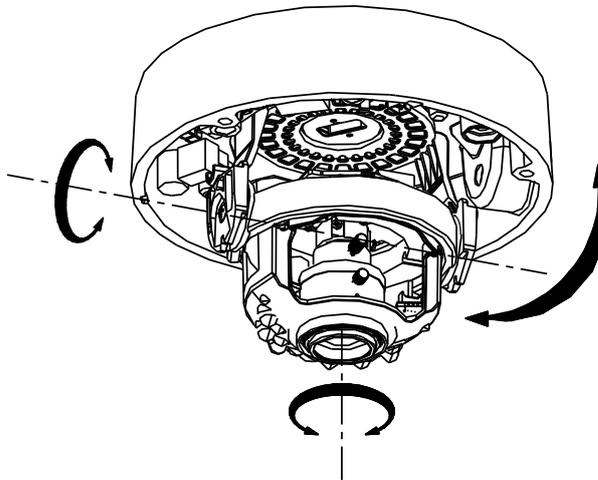
Рис.2.1.4. Настройка угла обзора и фокусировка объектива
