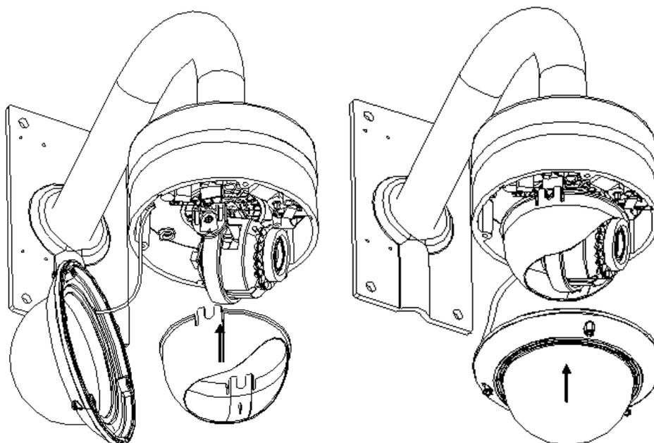
Рис.2.2.4. Завершение установки
