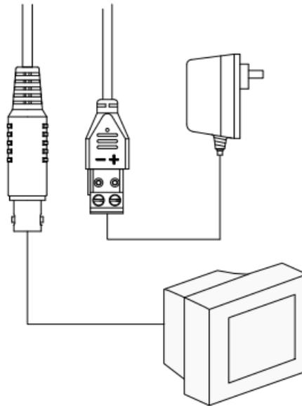
Рис.3.1.1. Подключение видеокамеры LTV-CCH-800L-V к монитору
