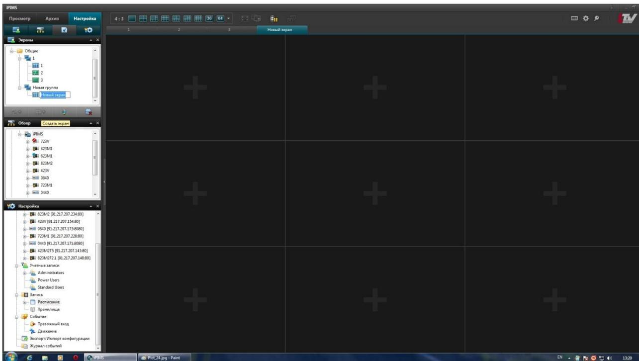
2.8. Из дерева «Обзор» мышью перетаскиваем камеры на выбранные поля мультиэкрана.
