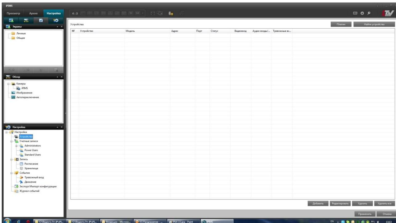
2.5. Добавляем IP-устройства, используя автопоиск (кнопка «Найти устройства») или ручную (кнопка «Добавить»). В окнах «Редактировать» и «Новое устройство» заполняем все поля. После добавления устройств обязательно нажимаем кнопку «Применить».
