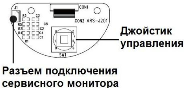
Рис.4.2.1. Управление видеокамерой LTV-CDH-821LHW-V2.8-12
