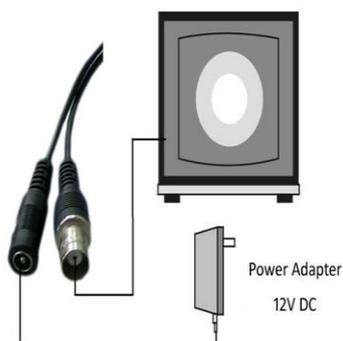
Рис.2.2.1. Коммутация разъемов видеокамеры
