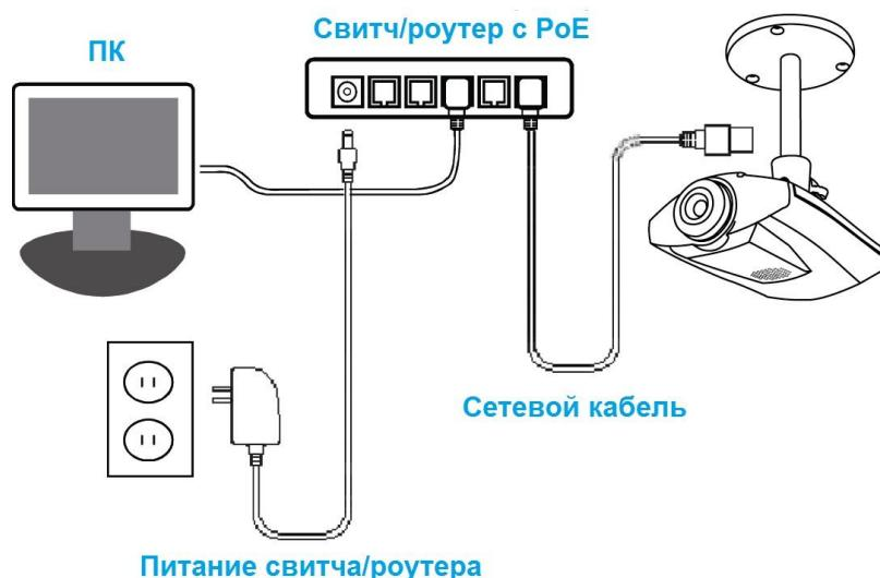
Рис.13.2.1. Схема подключения видеокамеры к сетевому оборудованию с поддержкой PoE
