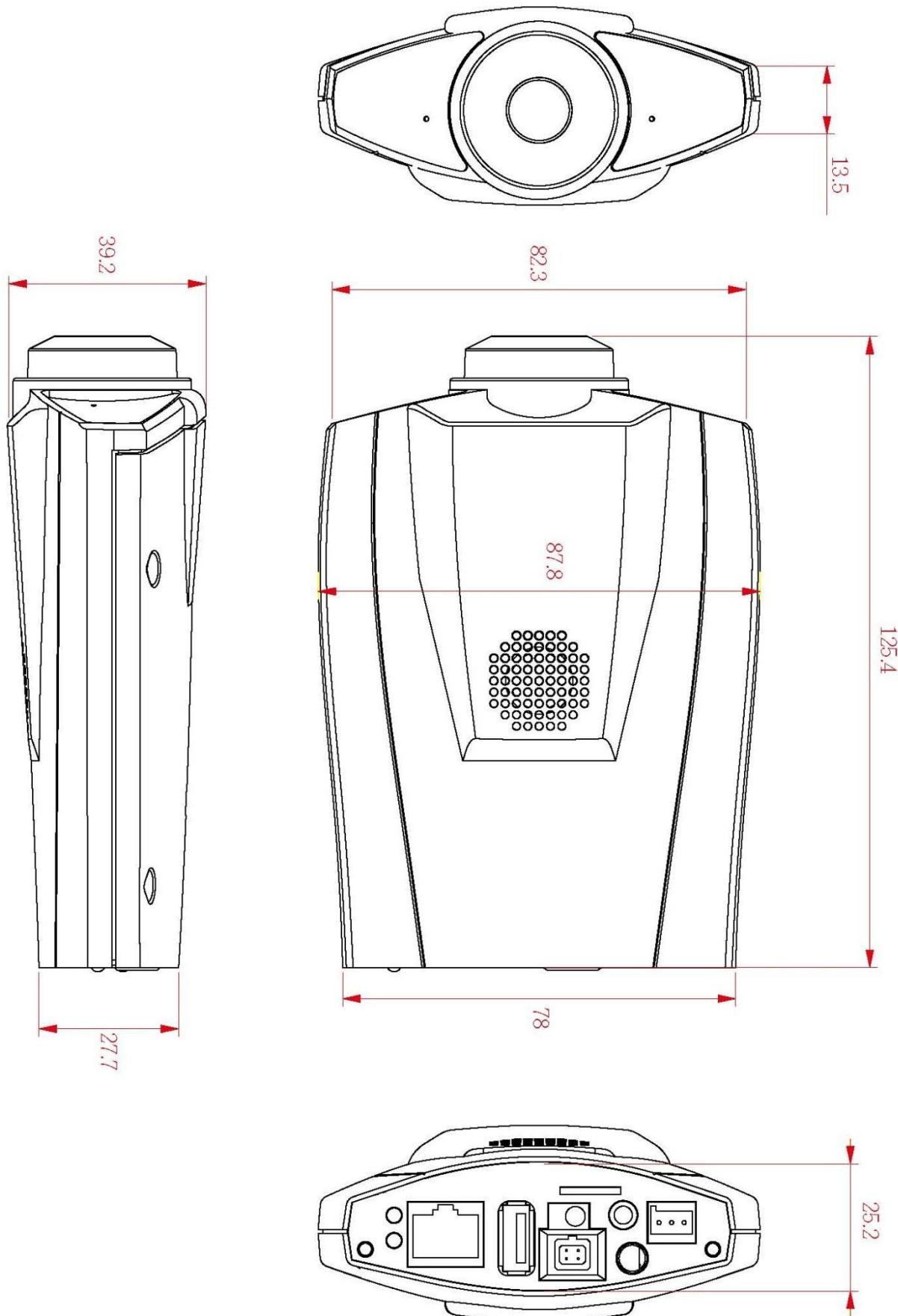
Рис.1.3.1. Габаритные размеры LTV-ICDM1-B423L-F
