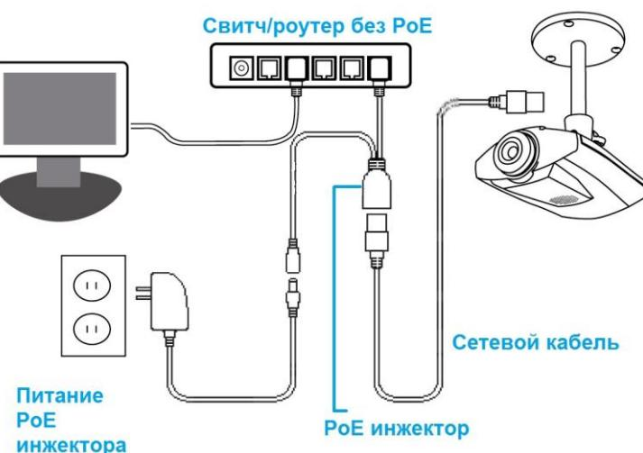
Рис.13.2.2. Схема подключения видеокамеры к сетевому оборудованию без поддержки PoE
