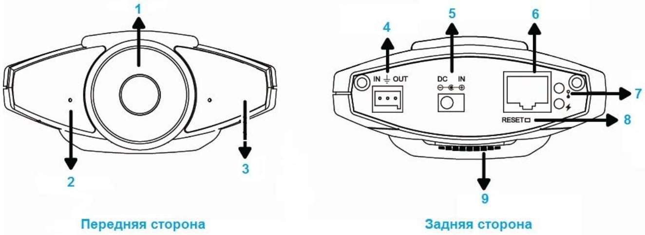
Рис.2.1.1. Описание видеокамеры LTV-ICDM1-B423L-F
