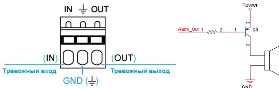
Рис.2.2.1. Схема подключения тревожных входа / выхода видеокамеры LTV-ICDM1-B423L-F
