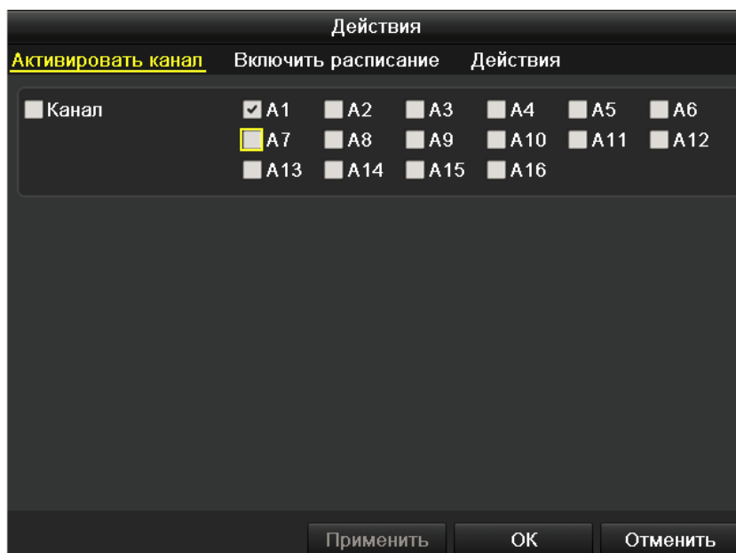
Рис. 8.1.3. Установка камер, реагирующих на тревогу
