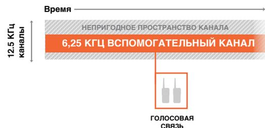
Протокол FDMA предполагает разделение полосы частот на несколько узких подканалов, но при этом пропускная способность канала 12,5 кГц используется не полностью. По мере сужения полосы возрастает угроза помех, снижается чувствительность и может уменьшиться радиус действия устройств – то есть, общее качество связи падает. Для решения этой проблемы требуются дополнительные лицензии и полосы частот, что делает систему значительно дороже.
