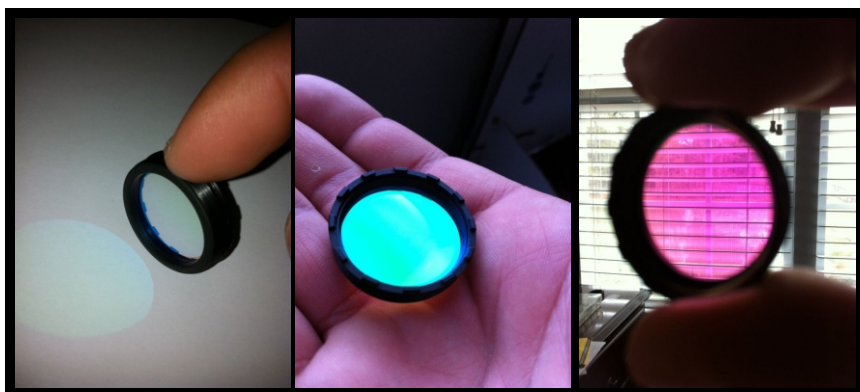
Интерференционный фильтр (ИФ) для защиты от лазерного излучения
