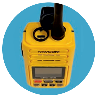
Герметичный разъем для зарядки и внешней гарнитуры на корпусе
