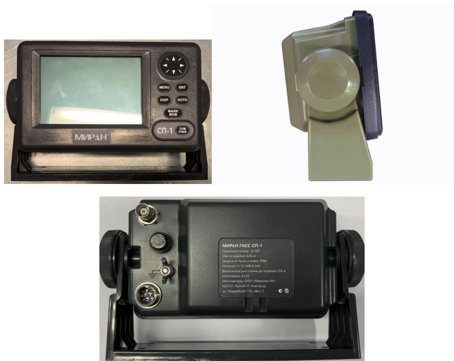
Рисунок 1. Внешний вид основного блока «Миран ГНСС-СП-1»
