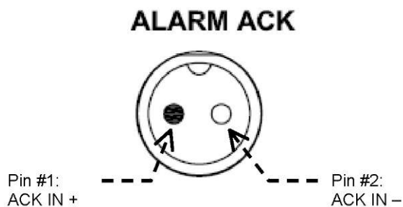
Рисунок 13-15 Распределение контактов разъема ALARM ACK
