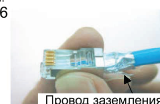
6 Провод заземления Вставьте кабель в модульный штекер так, чтобы отогнутая часть экрана входила в корпус штекера. Провод заземления должен быть расположен со стороны язычка.
