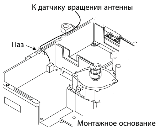
Как установить кабель датчика вращения
