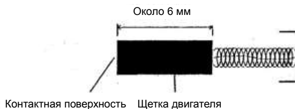
Рисунок 6.1. Инструкция по замене щеток электродвигателя
