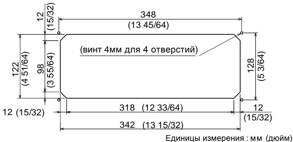
Рисунок 3.11 Схема выреза для рабочего блока
