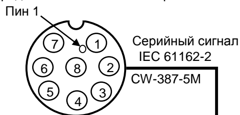
Распределение пинов коннектора кабеля АИС
