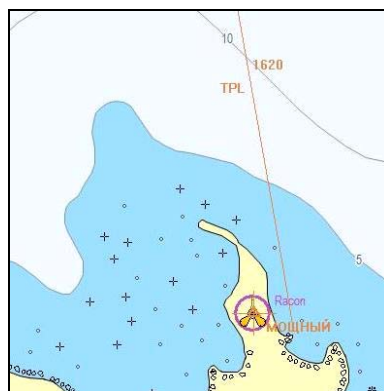
рис. 109 Отображение линий положения на карте
