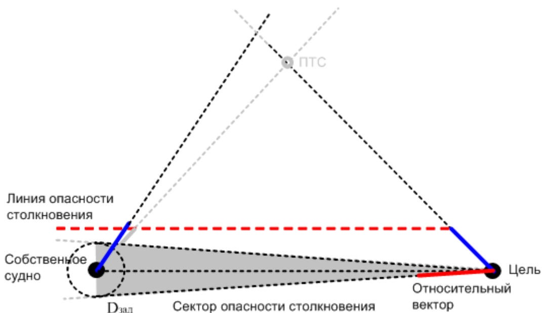
рис. 204 Сектор опасности столкновения, как он может быть представлен на дисплее САРП в режиме относительного движения. Дистанция безопасного расхождения D_{зад} установлена при помощи подвижного кольца дальности, центр ПКД – собственное судно.
