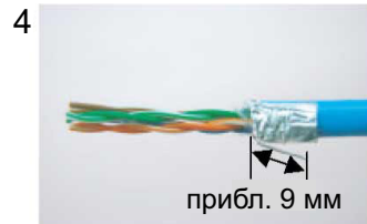
4 Отогните провод заземления и обрежьте его, оставив прибл. 9 мм.
