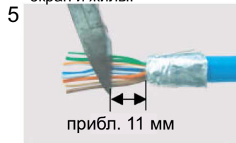
5 Раскрутите и выпрямите жилы по порядку и подрежьте их, оставив прибл. 11 мм.
