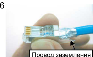
6 Вставьте кабель в модульный штекер так, чтобы отогнутая часть экрана входила в корпус штекера. Провод заземления должен быть расположен со стороны язычка.
